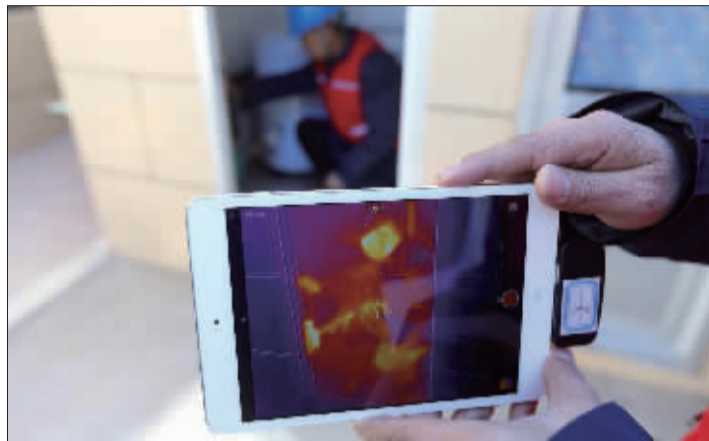
今天上午,北京电力公司的工作人员在实施了“煤改电”的顺义区东水泉村使用红外设备对电路进行检测,保障村民安全采暖 摄/记者 杨益
